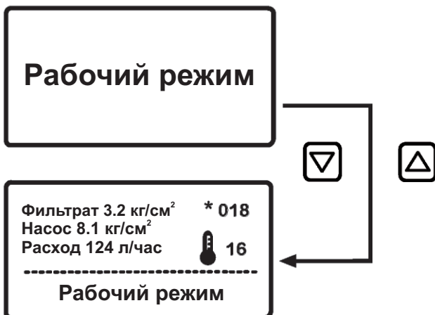
Рис. 5: Дисплей рабочего режима, сигнал давления отказа еще не получен.
