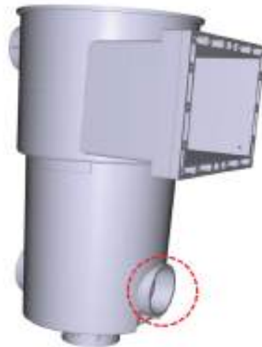
Figure 21 – Монтаж вставки-переходника на скиммер
