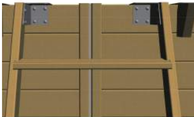
Figure 16 – Крепление лестницы с наружной стороны бассейна
